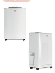
Involucro esterno realizzato in resina termoplastica ABS. Tanica in ABS traslucido con capacità pari a 2,5 l. Compressore rotativo con dispositivo di protezione che ne ritarda il riavvio di 3 minuti dopo ogni arresto. Umidostato, che consente di impostare il tasso di umidità residua dell'ambiente (40%, 50%, 60%, 70% O CONTINUO).
